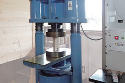
↓ ネジ引き抜き試験風景
