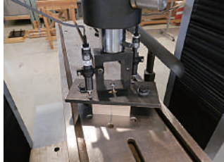
木ネジを打ち込み、それを引っ張り、どれだけの力で抜けるかを確認する試験。
