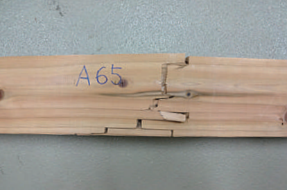
↓ 縦圧縮破壊例
