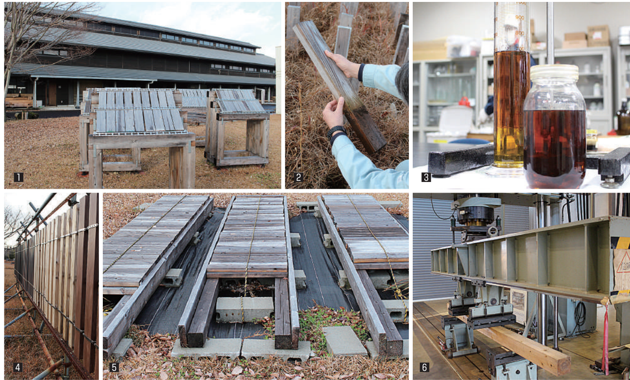
1 宮崎県木材利用技術センターでの直接大気暴露試験（斜め 45 度） 2 野外杭試験 3 飢肥杉赤身から抽出した精油成分 4 直接大気暴露試験（垂直） 5 ダブルレイヤー試験 6 曲げ強度試験
