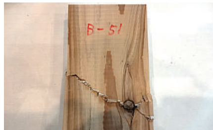
縦圧縮破壊例
