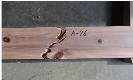
縦引張破壊例
